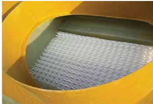
Рисунок 6 Вид коалесцентного модуля в маслобензоотделителе – основной элемент конструкции.
